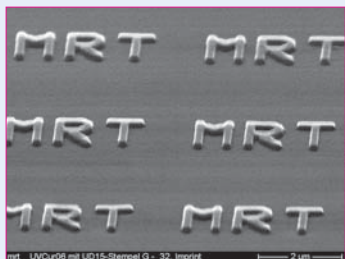
mr-UVCur06 mit UID15-Stempel G - 32, Imprint mr-UVCur06-Strukturen (32. Prägung mit OrmoStamp)
