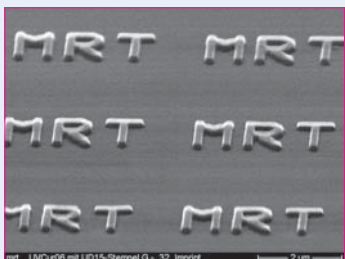
mr-UVCur06 mit UD15-Stempel G - 32, Imprint mr-UVCur06-Strukturen (32. Prägung mit OrmoStamp)
