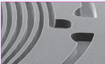
UV Strukturierte 30 \mu\text{m} hohe Spule
