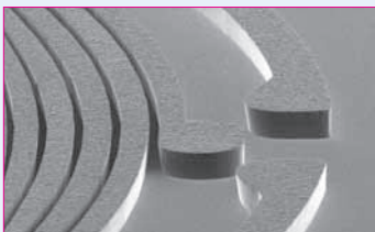
Galvanisch abgeschiedene Nickelspule 30 \mu\text{m}
